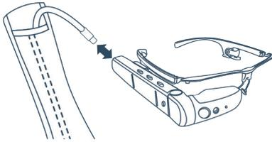
Verbinden Sie den blauen USB-C-Anschluss mit der Vuzix M400.
