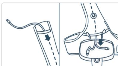
Führen Sie das Y-Kabel durch den Holster mit dem doppelten Ende nach unten und dem einfachen Ende nach oben.
