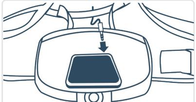
Verbinden Sie die Ohrhörer mit dem Gerät und schließen Sie den Reißverschluss des Holsters.
