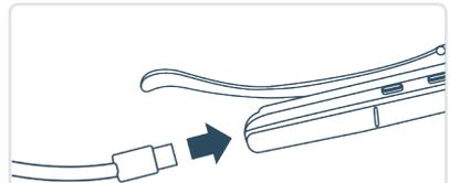
Schließen Sie das USB-C-Kabel an die Vuzix M400 an.
